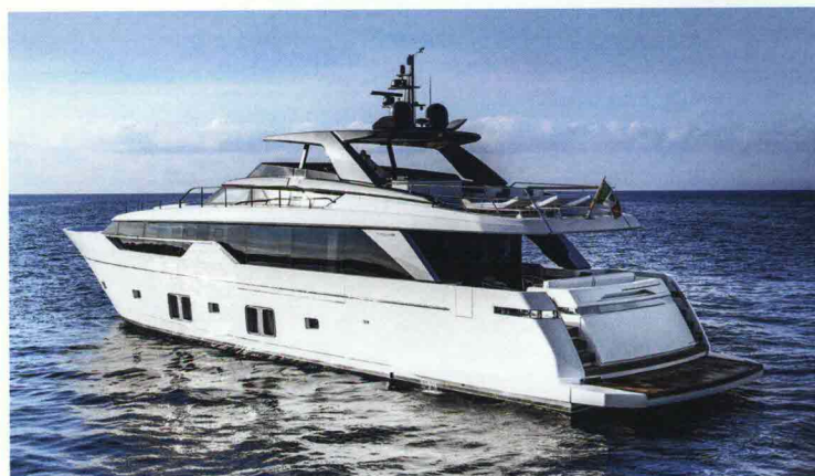
Kaum zu erkennen: An Backbord fehlt der asymmetrischen SL102 das Seitendeck. Durch cleveres Design schaffte es das Duo Bangle/Zuccon, dies zu verschleiern.
